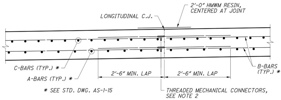
APPROACH SLAB CONSTRUCTION JOINT DETAIL
