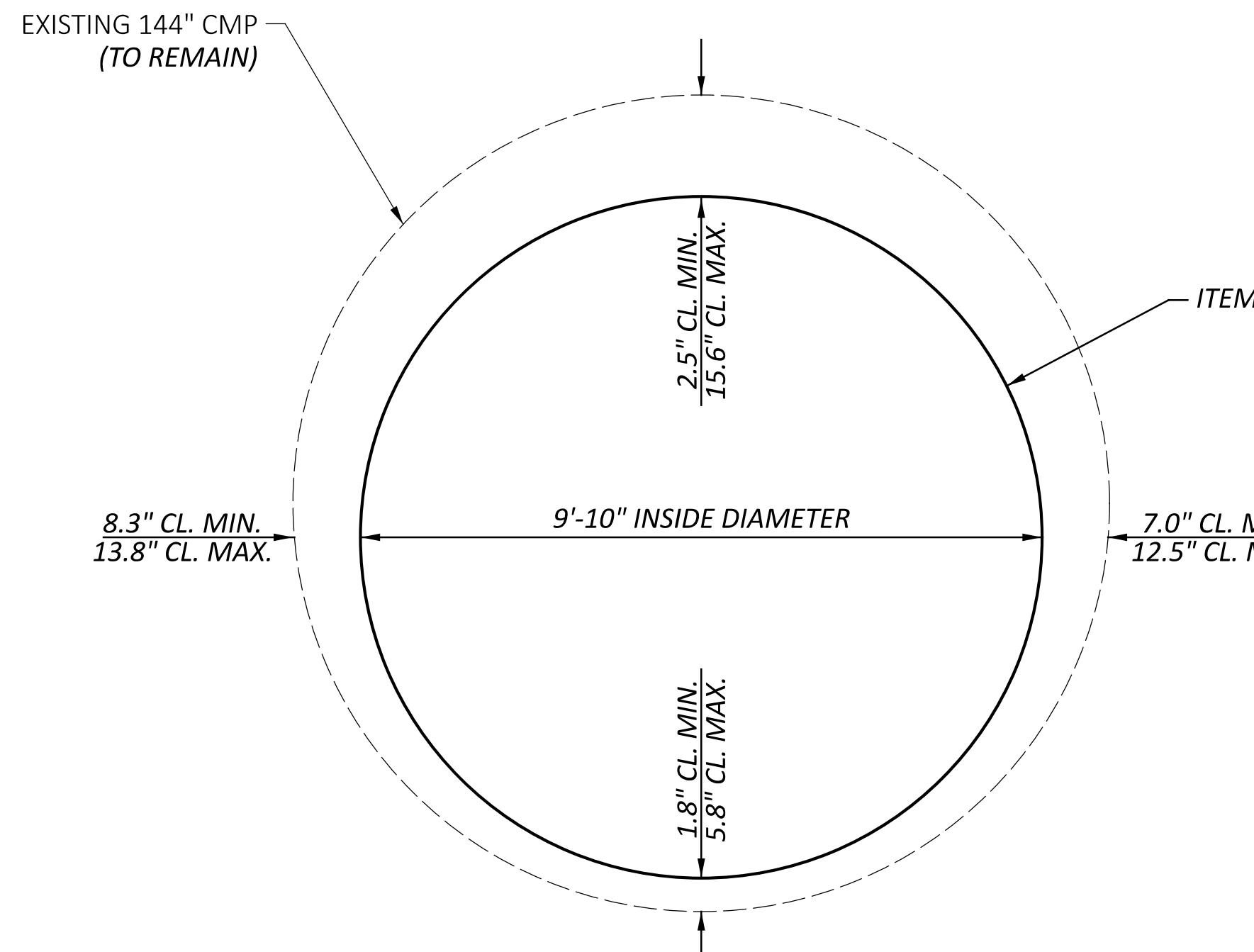
TYPICAL CULVERT LINING SECTION
