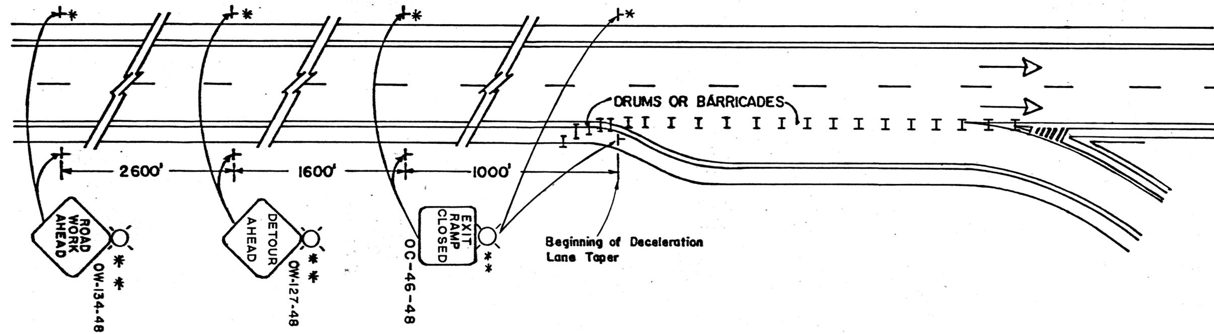
\*\* TYPE A FLASHING BARRICADE WARNING LIGHTS ARE REQUIRED FOR NIGHT LANE CLOSURES.
