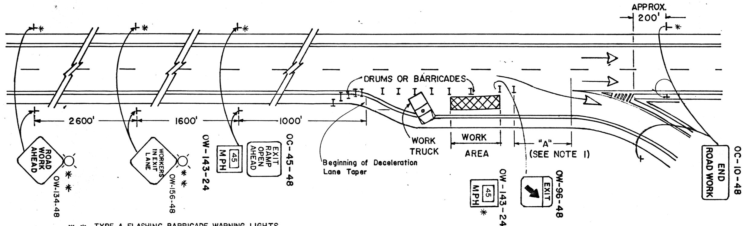
\*\* TYPE A FLASHING BARRICADE WARNING LIGHTS ARE REQUIRED FOR NIGHT LANE CLOSURES.
