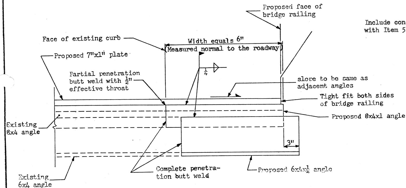
**WELDED BUTT JOINT IN SUPERSTRUCTURE END DAM**
