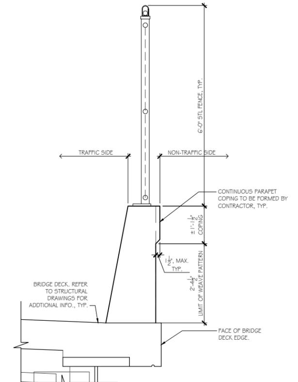
**4** TYPICAL DETAIL: PARAPET WALL
