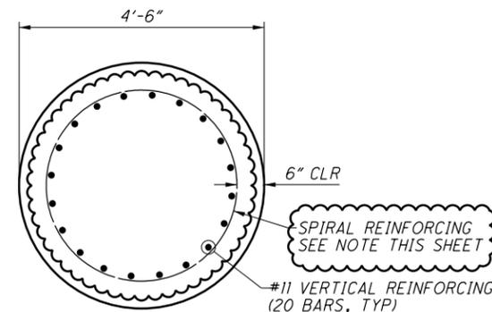
TYPICAL PIER DRILLED SHAFTS
