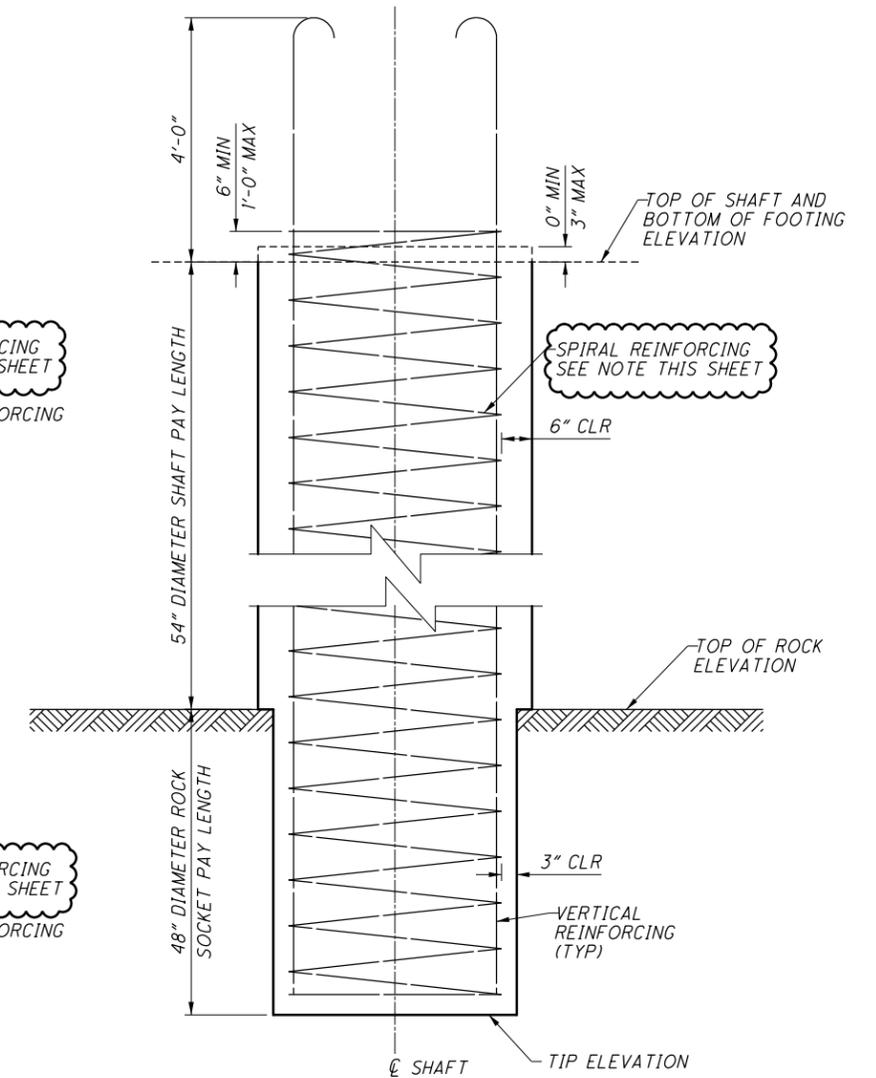
TYPICAL PIER DRILLED SHAFT ELEVATION
