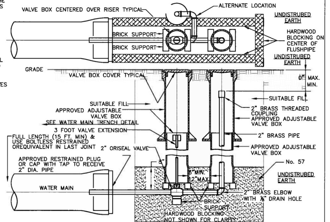
**TYPICAL FLUSHING ASSEMBLY (STD-003)**
