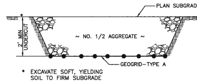
SUBGRADE STABILIZATION DETAIL
