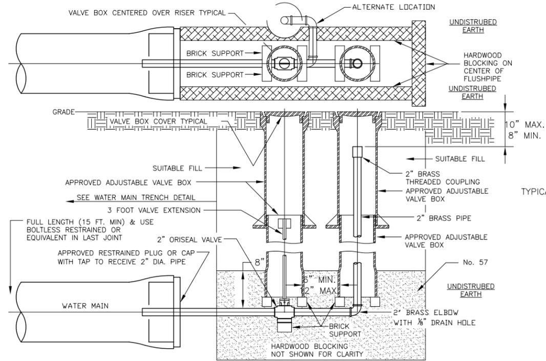
**TYPICAL FLUSHING ASSEMBLY**
