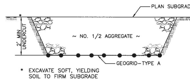
SUBGRADE STABILIZATION DETAIL
