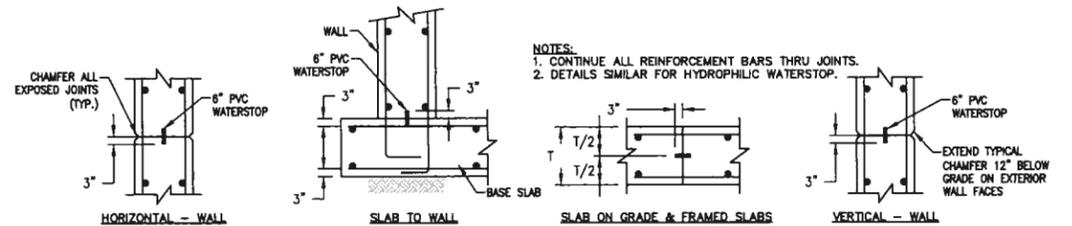
TYPICAL CONSTRUCTION JOINT DETAILS
