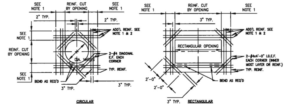
TYPICAL REINFORCEMENT AROUND OPENING IN WALL AND SLAB
