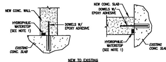
TYPICAL CONSTRUCTION JOINT DETAILS AT NEW TO EXISTING
