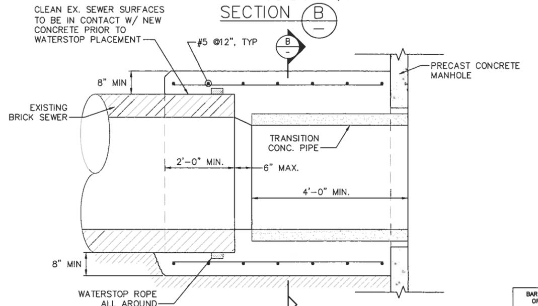
TYPICAL EXISTING BRICK-TO-RCP CONNECTION DETAIL
