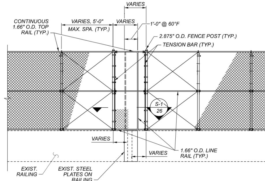
**TYPICAL FENCE DETAIL AT EXPANSION JOINT**
