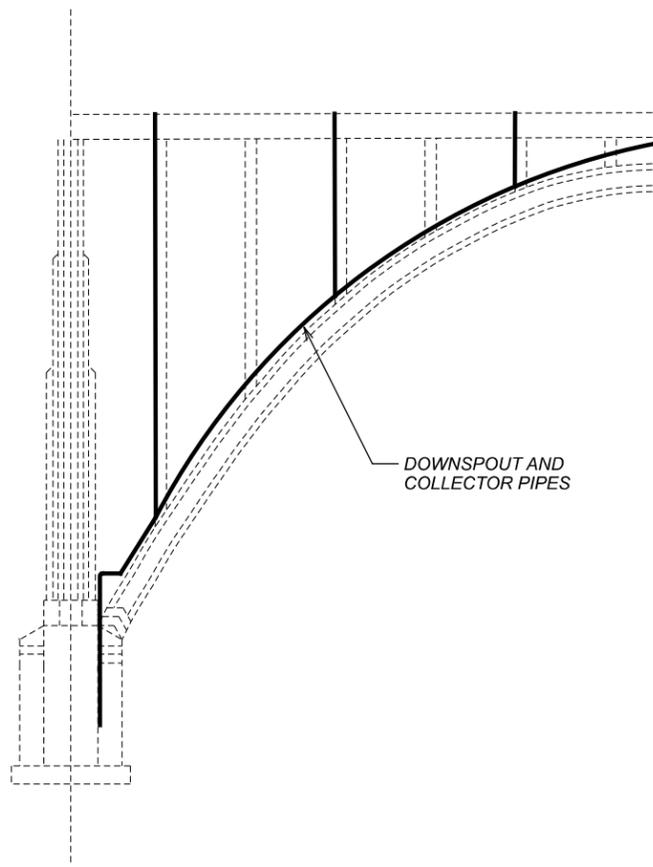
TYPICAL DRAINAGE IN ARCH SPANS
