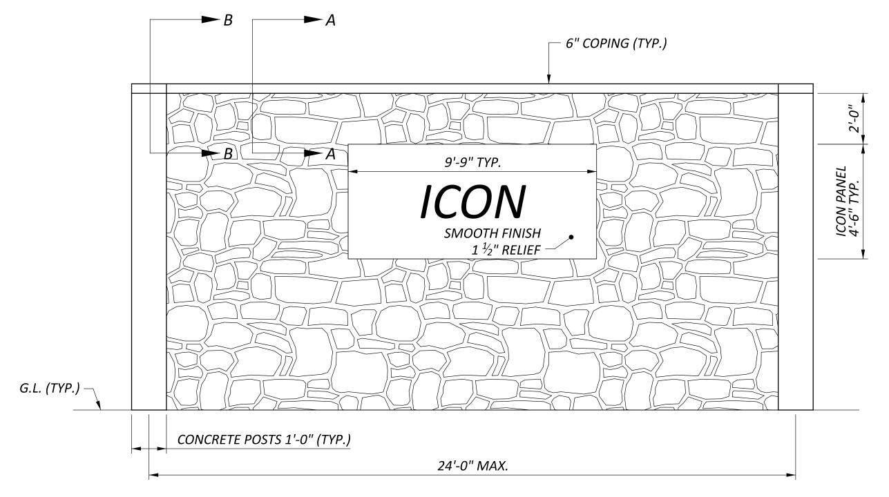
NOISE BARRIER DETAIL - ARCHITECTURAL POLYMERS LARGE STONE OHIO DRYSTACK #9110
