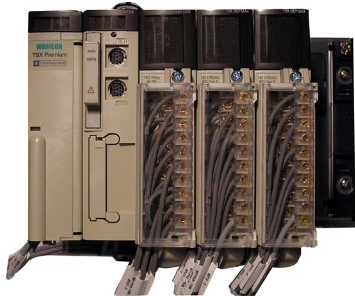
Figure 18 : Assemblage de l'automate
