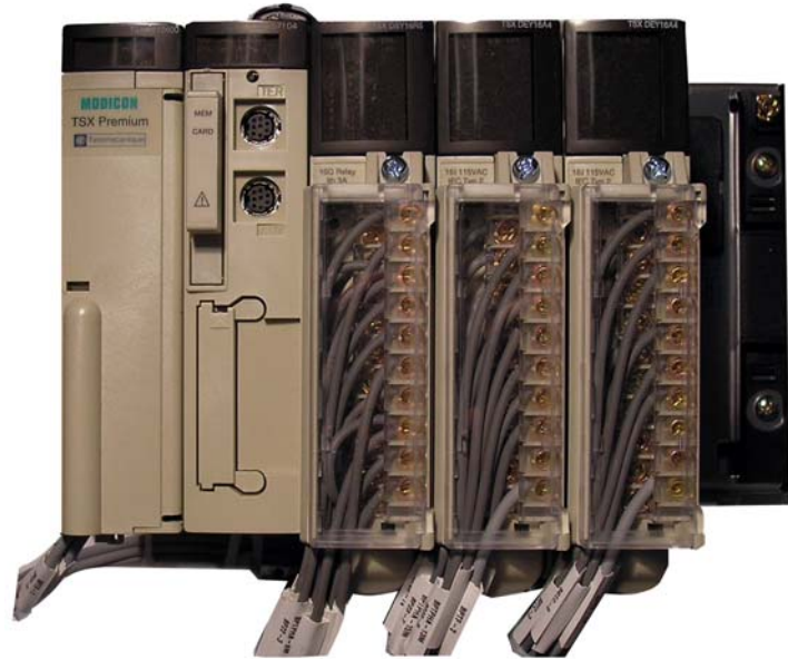
Figura 18: Ensamble del PLC
