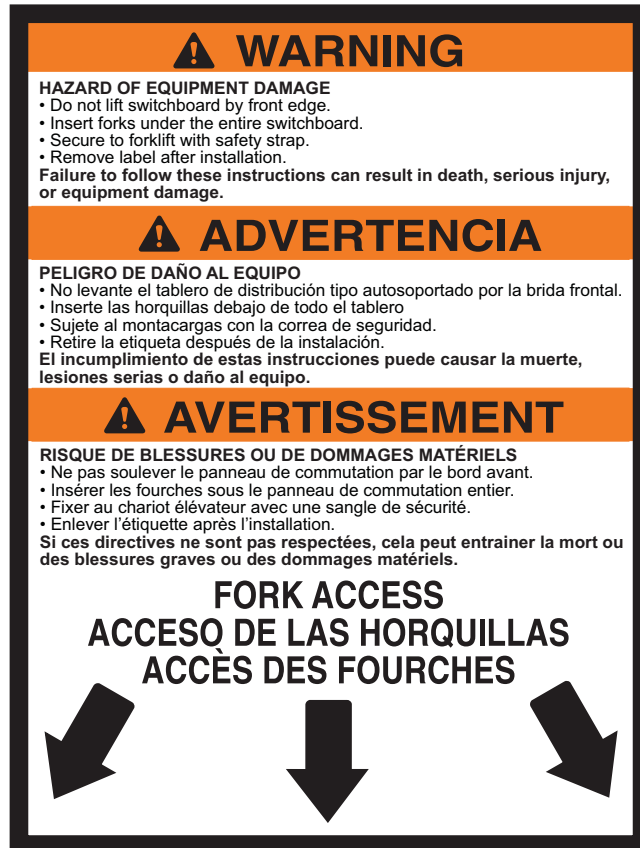
Figura 2 – Etiqueta de advertencia – Tableros de distribución tipo autoportado a prueba de lluvia
