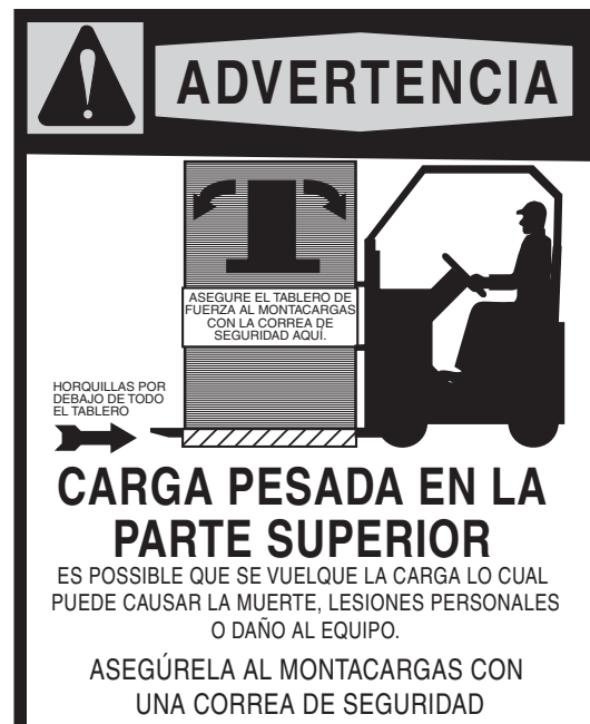
Figura 6: Correa de seguridad del montacargas
