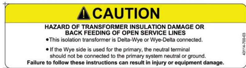
Figure 32 : Étiquette d'attention pour les transformateurs raccordés triangle-étoile ou étoile-triangle
