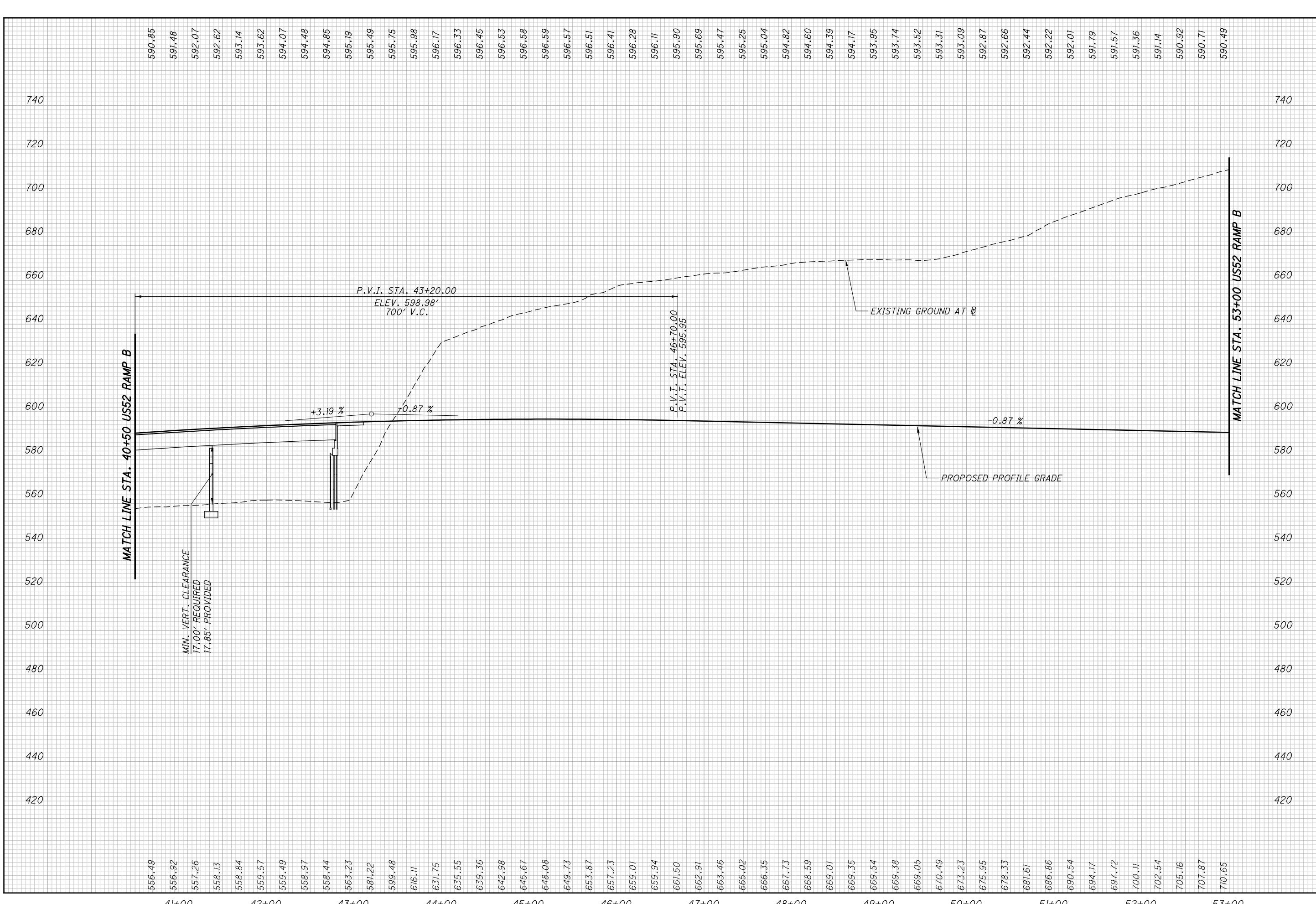
**NOT FOR CONSTRUCTION****SCI-823-0.00****PROFILE - US52 RAMP B****CALCULATED****LBD****CHECKED****JBH****97****623**
