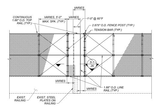
TYPICAL FENCE DETAIL AT EXPANSION JOINT
