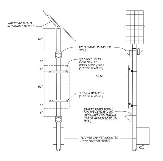
DETAIL 2 - FRONT VIEW DETAIL 3 - SIDE VIEW
